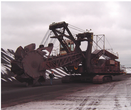
Fig. 6: Uno de los tres elevadores a cangilones de 4000 toneladas por hora con una antigüedad de 40 años, reemplazado por un BNSF con tres Poleas Motorizadas Rulmeca (uno en la pluma y dos en la cola).
