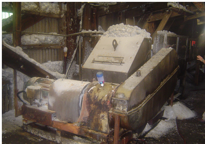
Fig. 4: Un sistema original de transmisión del transportador en las operaciones de Cargill en Avery Island con un conjunto de motor expuesto, caja de engranajes y cadena/rueda dentada.
