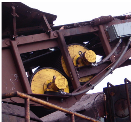
Fig. 7: La disposición de "transmisión doble anidada" con dos Poleas Motorizadas produjo 420o grados de arrollamiento en la banda, reduciendo el requisito de tensión del lado flojo en un 29 por ciento.
